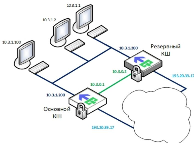
Если оба КШ расположены в одной серверной стойке, для их соединения используется сетевая кросс-кабель. В остальных случаях соединение криптографических шлюзов осуществляется через IP-сеть.
