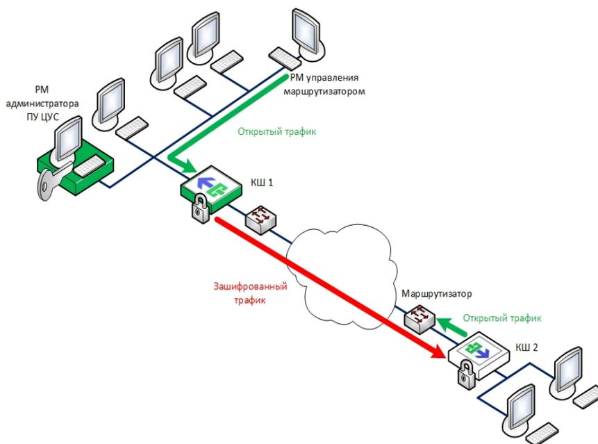
Таким образом, исходный управляющий трафик от консоли управления зашифровывается КШ 1 и по общей сети передается в зашифрованном виде на КШ 2. КШ 2 расшифровывает трафик и передает его в открытом виде на маршрутизатор. IP-пакеты отсылаются маршрутизатором к консоли управления тем же путем в обратном порядке.
