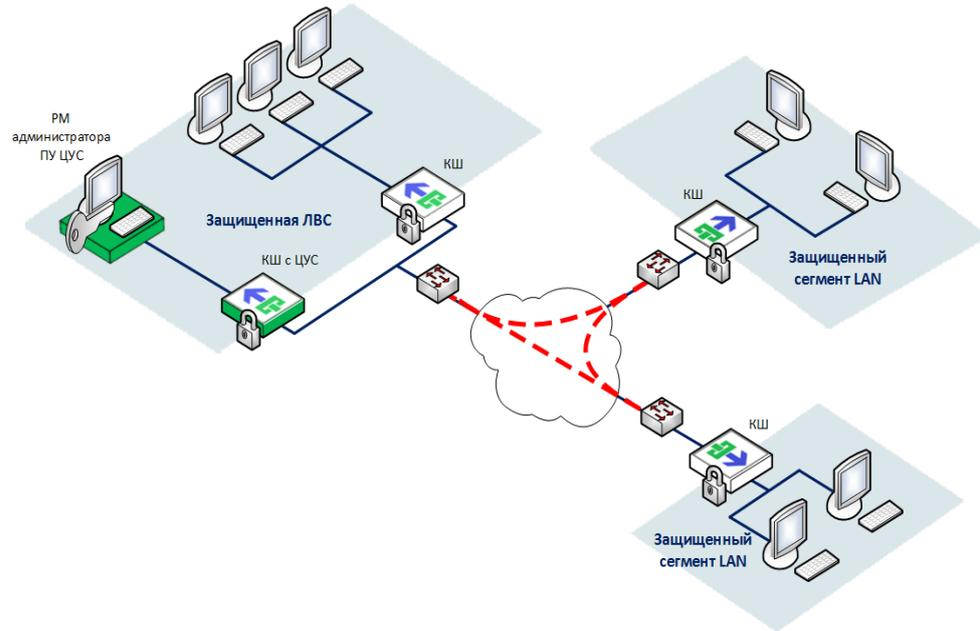
Автоматическое управление сетевыми устройствами осуществляет ЦУС, размещающийся на одном из криптографических шлюзов. Этот КШ можно использовать как любой другой рядовой шлюз в корпоративной сети для приема и передачи IP-пакетов, их фильтрации, маршрутизации и криптографического преобразования.
